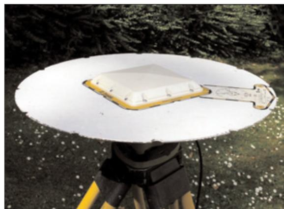
Abb. 16: Trimble-Microcentered-Antenne (TRM33429.00+GP) mit Grundplatte (Foto: Galitzki)
