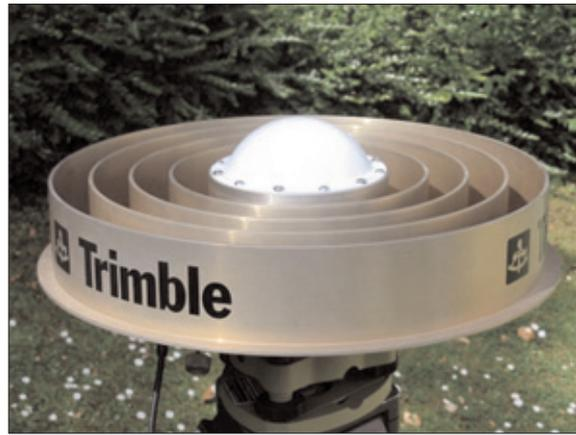
Abb. 11a: Trimble-Choke-Ring-Antenne (TRM29659.00) ohne Radom (Foto: Galitzki)
