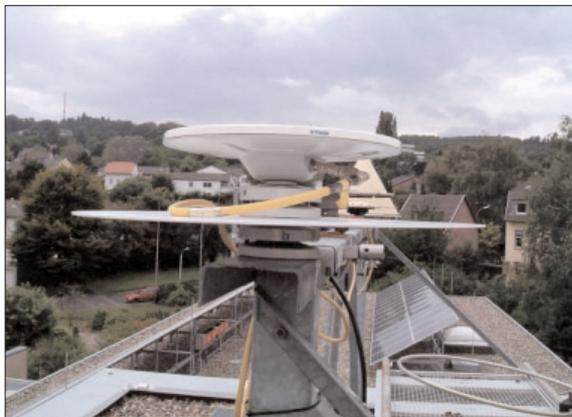
Abb. 15: Trimble-Zephyr-Geodetic-Antenne (TRM29659.00) mit zusätzlichem Dreifuß auf Grundplatte, hier ohne Radom (Foto: Galitzki)
