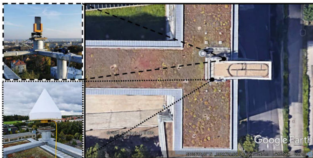
Abb. 1: Messanordnung auf dem Dach eines Bürogebäudes in Dresden (Rahmen mit durchgezogener Linie, Quelle: www.google.com/earth ), Smartphone mit Hal- terung (Rahmen mit gestrichelter Linie), Antenne der Refer- enzstation (Rahmen mit gepunkteter Linie)
